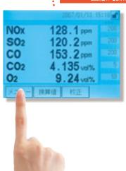
表示一体型の大型タッチパネル式LCDを採用。 主要5成分(NOx、SO2、CO、CO2、O2)をワン パネルに同時表示。多成分の濃度変化を一度に、 リアルタイムに確認することができます。校正、 換算濃度設定画面の切り替えや警報時の内容は、 指一本で簡単操作。校正、アラーム履歴は画面 上で確認が可能なため、維持管理作業を効率化 することができます。
