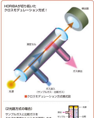
それぞれ専用セルに入れて測定します。 ≫ラボユースなどのバッチ測定に適した方式です。
